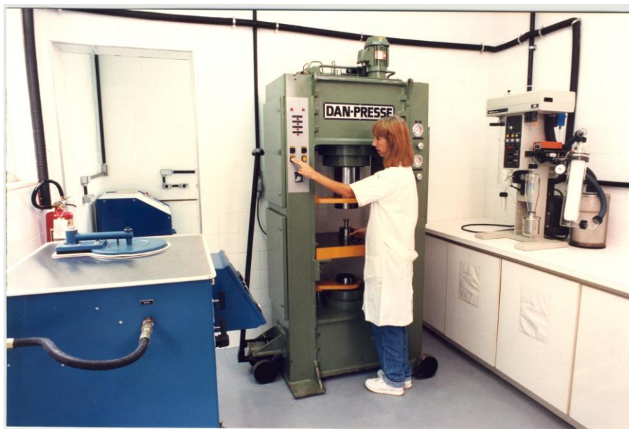
Prensa hidráulica axial de duplo sentido utilizada na conformação de peças cerâmicas
